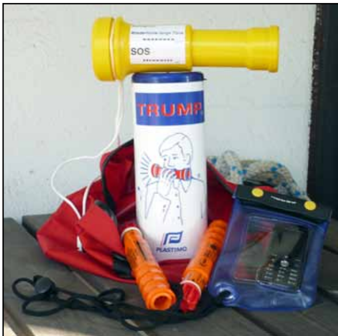
Basisausstattung für den Notfall: wasserdichte, bedienbare Handytasche und am Boot anzubindende Notfallbox mit Signalhorn und drei Rauchhandfackeln (rot)
